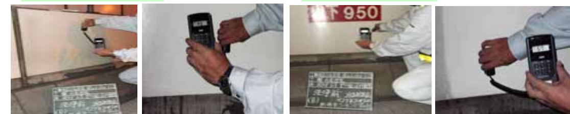
洗浄前光沢度 16 洗浄後光沢度 45 洗浄前光沢度 17 洗浄後光沢度 57
